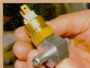
Der Temperaturfühler für die Umschaltung von Diesel auf Salatöl wird in der Wasserleitung zur Innenraumheizung installiert
