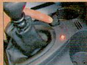
Einzige Details im Cockpit: der Warntongebner (nicht im Bild), der Umschalter für den Kraftstoff (oben) sowie die Kontrollleuchte (unten)
